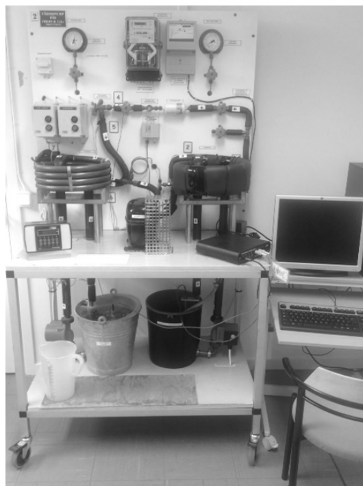
Figur 7. Laborationens värmepumpsanläggning med inkopplat mätsystem.
