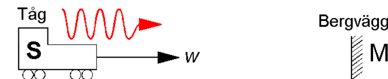
Figur 1 Ett tåg på väg mot en tunnel avger en varningssignal som reflekteras i bergväggen.
